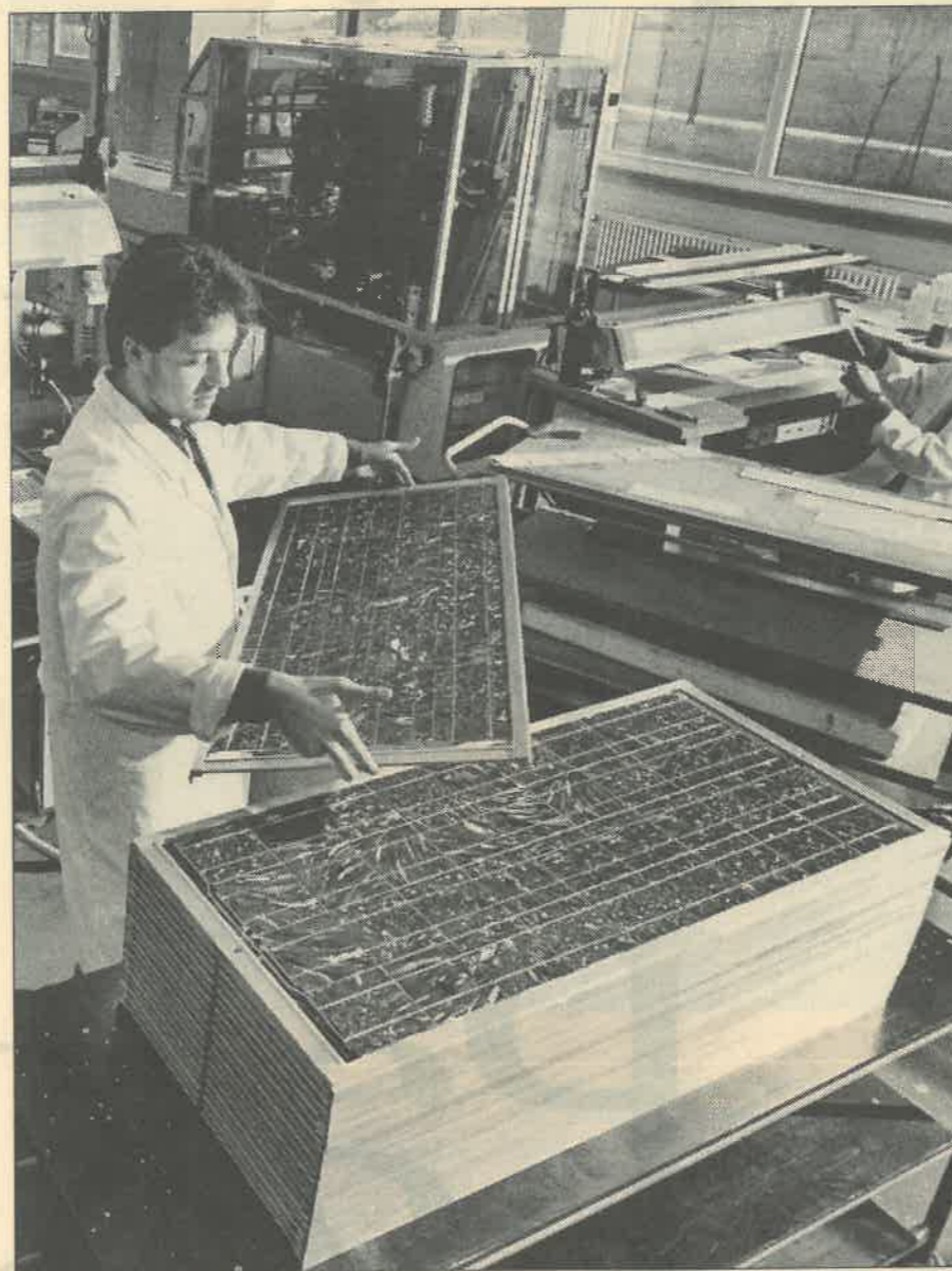
Bei der heutigen Produktion von Solarzellen geschieht noch vieles per Hand, wie hier in Wedel die Kontrolle der einzelnen Module. An diesem Standort wurden bislang jährlich Photovoltaik-Anlagen für 400 Einfamilienhäuser produziert. Ende des Jahres verlegen RWE und Daimler-Benz diese Fertigung in die USA. Foto: Argus
