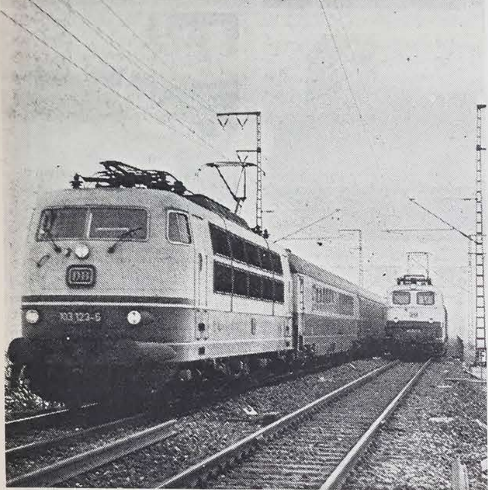
Der Gleiswechselbetrieb ermöglicht das Benutzen beider Gleise in beiden Richtungen und damit auch das Überholen auf freier Strecke. Er sichert das Erhöhen der Zugfolge vor allem auf den Ausbaustrecken.
